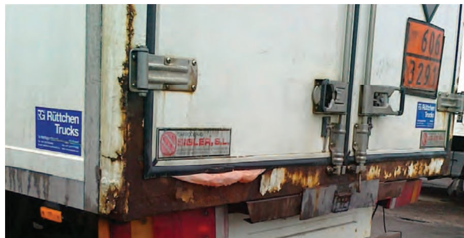
6. Uszkodzone uszczelki i niestaranie zamknięte drzwi
