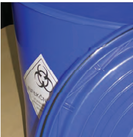
8. Klinix Box – opakowanie służące przewozu m.in. części ciała. Brzeg bębna posiada ostry brzeg, natomiast w pokrywie jest silikonowa uszczelka. Po zatrzasknięciu pokrywy opakowanie jest szczelne, a konstrukcja zatrzasków uniemożliwia ponowne otwarcie opakowania bez jego uszkodzenia
